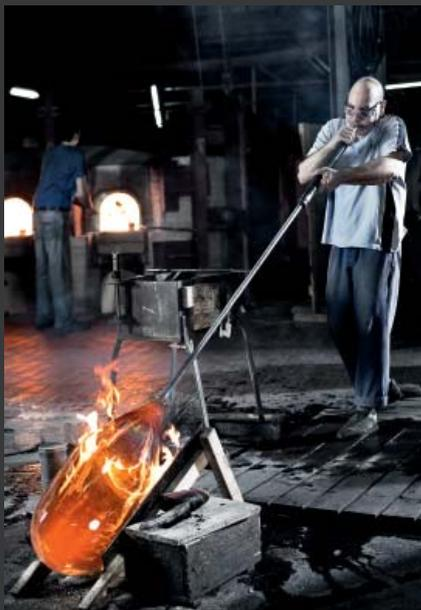
Durch gleichzeitiges Drehen und Blasen des Glasballons entsteht die für mundgeblasene Gläser typische Bewegung in der Glasoberfläche.
